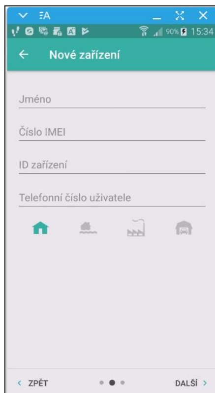
Obr. 37. Aplikace GX Control (systém Android): manuální konfigurace parametrů nového modulu.
